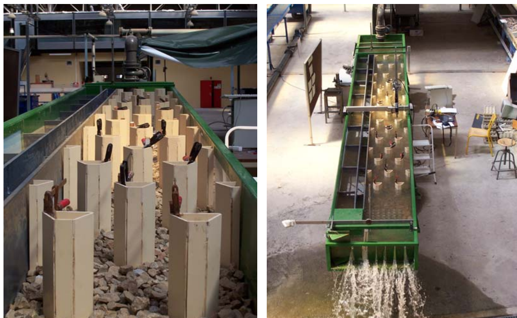
Figure 4. Canal à rugosités artificielles.
