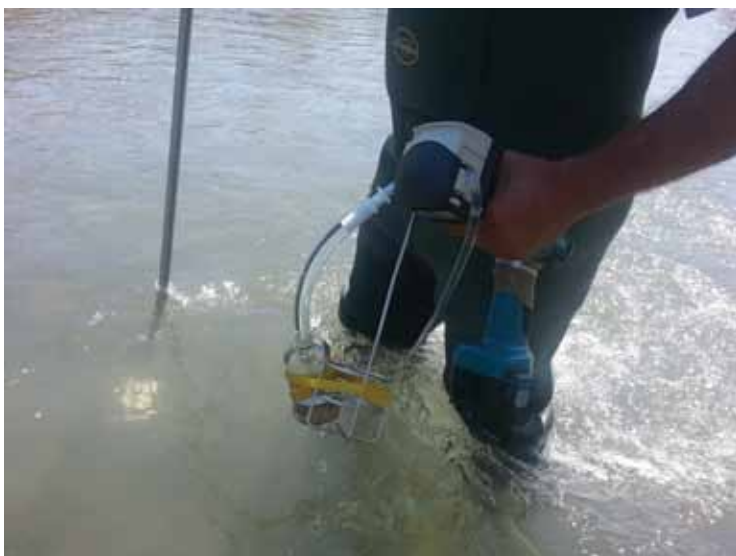
Photo 4 : Filtration de l'eau à l'aide d'une pompe péristaltique © Spygen
