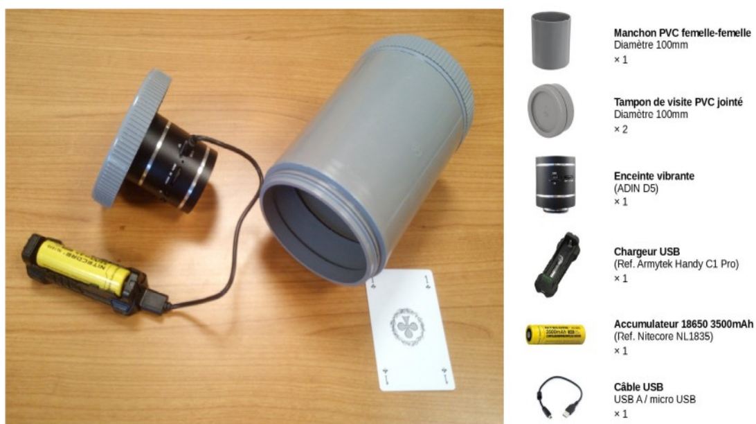
Figure 2: Composants et assemblage du dispositif de diffusion acoustique subaquatique.
