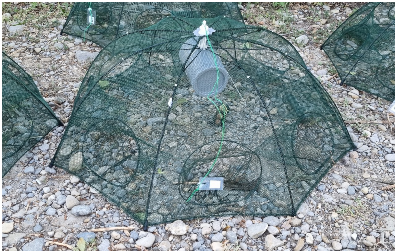
Figure 3: Dispositif expérimental de piégeage. Chaque nasse est équipée d'une enceinte subaquatique diffusant un leurre acoustique ou du silence. Les nasses comportent 8 entrées, mesurent 30 cm de hauteur et 95 cm de diamètre et possèdent un vide de maille de 2,5 mm.
