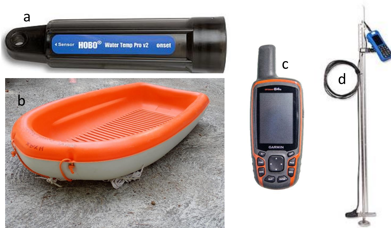
Figure 2 : Photos du matériel utilisé : a) Enregistreur de températures b) embarcation c)GPS d) courantomètre
